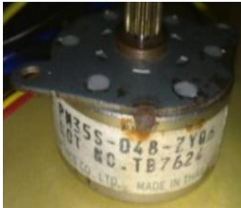
Fig. 5. Stepper Motor
